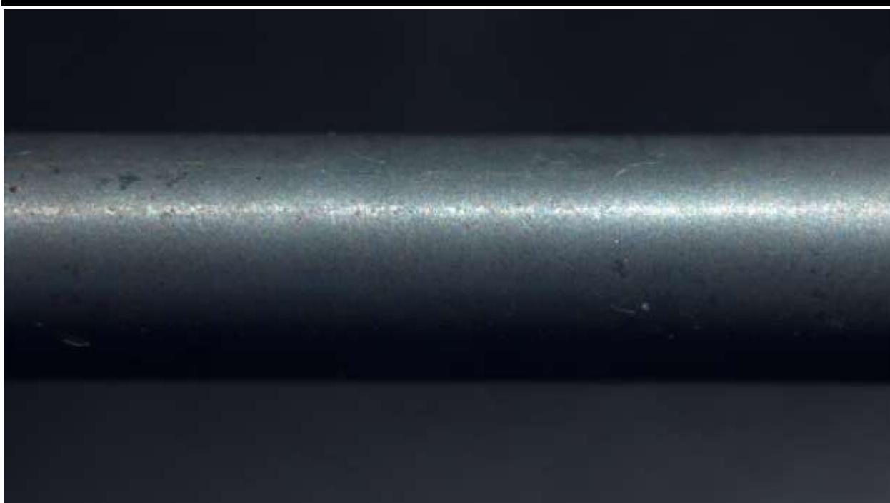
Şəkil 3. CO 2 ilə doymuş suda 1%-li NaCl məhlulunda 50 mq/l C 12 nitrobirləşmənin natrium duzunun (aktiv maddə 10 mq/l) iştirakı ilə 20 saat korroziya prosesindən sonra polad elektrodun mikroskopda 40 dəfə böyüdülmüş səthinin şəkli.
