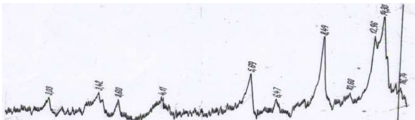
Şəkil 2. Co (4-Cl, 2 – NO 2 C 6 H 3 CO 2 ) 2 · 3H 2 O kompleks birləşməsinin difraktoqramı.
