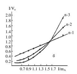
Определение соотношения компонентов: в ассоциате хлориндата по методу сдвига равновесия (а); в ассоциате броминдата по методу прямой линии (б).  $(C_{In}=4.64\cdot10^{-5} M,~\lambda_{AJAH}^{max}=520~\text{нм};~\lambda_{AJAH}^{max}=530~\text{нм},~l=1.0~\text{см},~C\Phi-46).$
