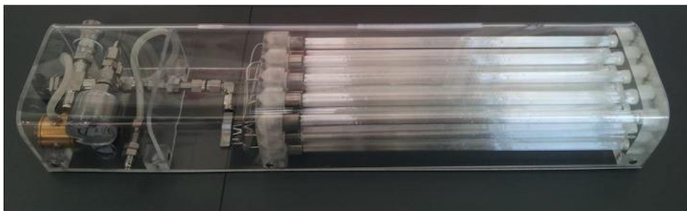
Рис. 13. Водородный контейнер на основе стеклянных мультикапилляров компании INCOM (США), максимальное давление 150 МПа [109].
