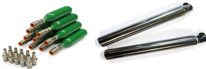
Рис. 2. Контейнеры фирмы Pragma Industries для хранения водорода в AB_5 интерметаллидах на 10 л, вес контейнера 112 г, (слева) и 20 л вес контейнера 350 г, (справа). Загрузка при 1 МПа, разгрузка при 0,2 МПа и 20 °С. [37]
