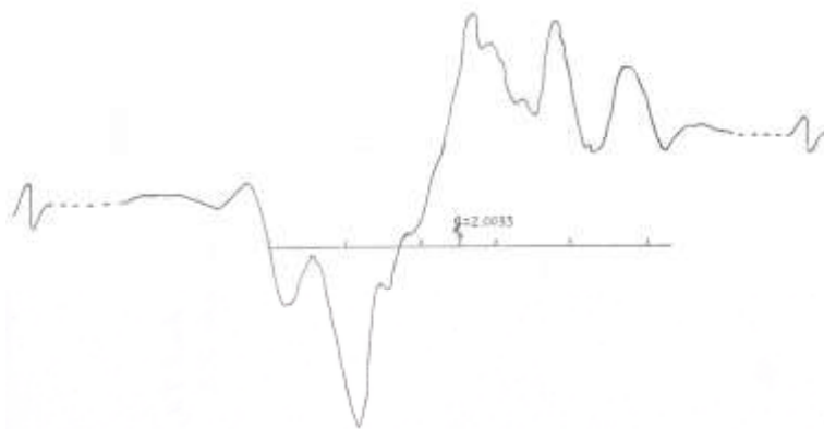
Рис.2. Спектр ЭПР \gamma -облученной системы \gamma\text{-Al}_2\text{O}_3 + \text{n-C}_6\text{H}_{14} + \text{H}_2\text{O} при T=77\text{K} и \dot{D}=1.01\text{Гр/с}
