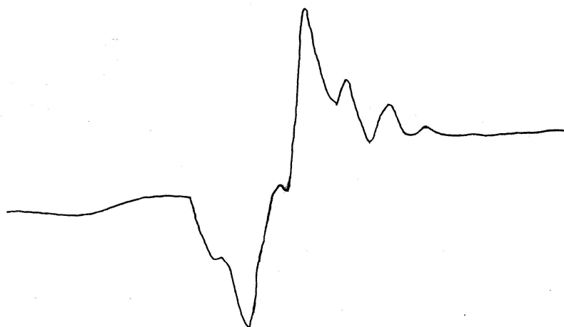
Рис.1. Спектр ЭПР \gamma -облученной системы \gamma\text{-Al}_2\text{O}_3 + n\text{-C}_6\text{H}_{14} при T=77\text{K} и \dot{D}=1.01\text{Гр/с}
