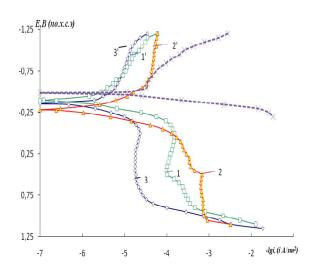
**Рис.1.** Анодные (1,2,3) и катодные (1',2',3') поляризационные кривые стали 35ГС, обработанной в различных засыпках. Раствор - 3%-ный NaCl. Номера кривых соответствуют номеру засыпки в табл.1. Пунктир – сталь без покрытия.
