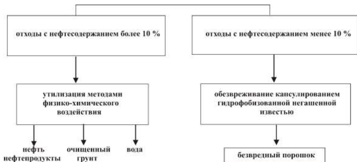
Рис.2. Схема переработки отходов бурения и нефтедобычи: донных осадков земляных амбаров и нефтезагрязненного грунта.
