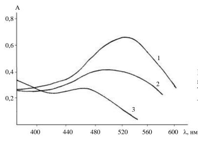
**Рис.2.** Спектры поглощения комплекса Ti(IV)-оКБАП-ЦП — 1, Ti(IV)-оКБП-ЦП — 2, оКБАП-ЦП — 3.
